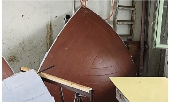
Fast nicht zu unterscheiden vom früheren Original: die neuen Halbkugeln aus Fieberglas.
